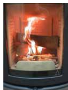
III.4 : Chiusura presa dell'aria primaria
