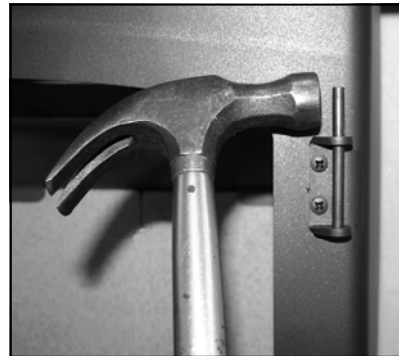
Fig. 6 Adjusting Door Hinges
