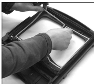
Fig. 8a Fitting New Door Gasket
