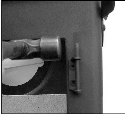
Fig. 7 tapping door hinges
