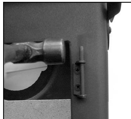
Fig. 13. Adjusting the door hinge
